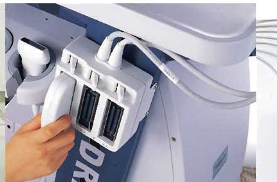
Возможность подключения дополнительного адаптера с 3-мя портами датчиков
