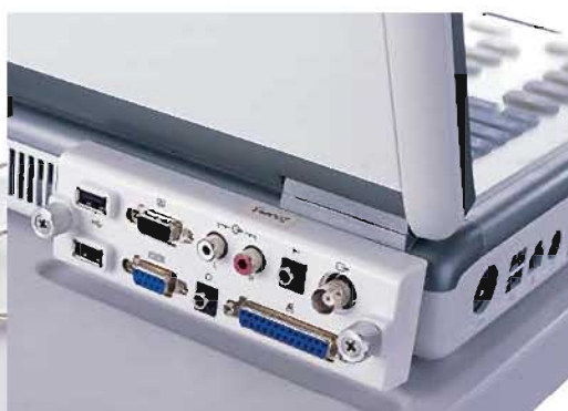
iDock™ для связи с различными периферическими устройствами
